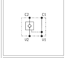
**DATI TECNICI / TECHNICAL DATA** Coppia di serraggio 70-80 Nm (max 80°) Installation torque Pressione di lavoro max. 350 bar Max. working pressure Portata max. 30 l/min Flow max. Rapporto di pilotaggio 4.6:1 Pilot ratio Peso 0.7 kg Weight Per un funzionamento corretto scegliere il rapporto di pilotaggio in funzione della
